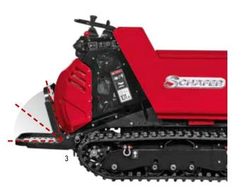
Die Mitfahrplattform kann für den Transport oder auf engen Baustellen einfach nach oben geklappt werden.
